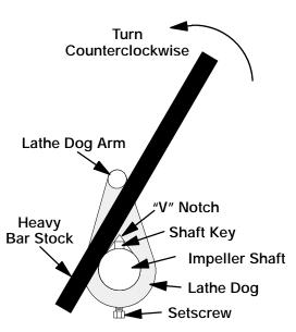
Figure C--6. Loosening Impeller
