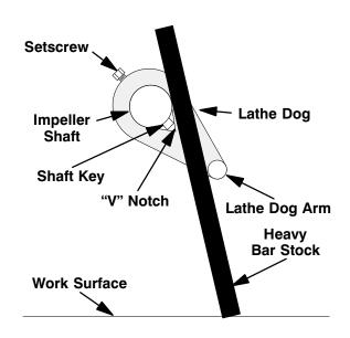
Figure E-2. Blocking Shaft Rotation
