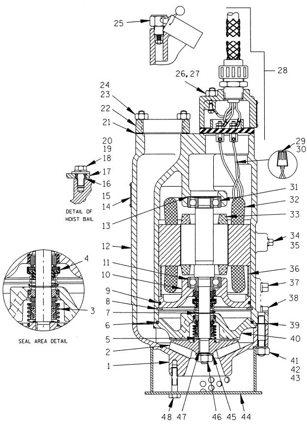
Figure 1. Pump Model S2F1-E1
