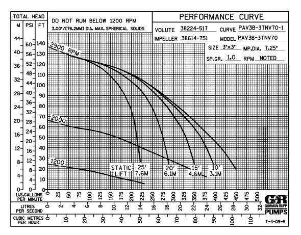
\* STANDARD PERFORMANCE FOR PUMP MODEL PAV3B60C-3TNV70
