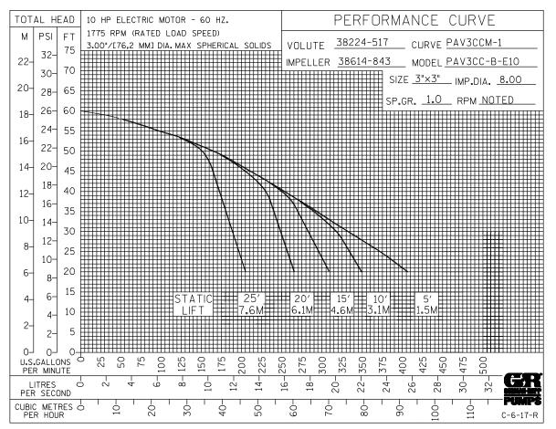
\* STANDARD PERFORMANCE FOR PUMP MODEL PAV3C60C-B-E10 460/575/3
