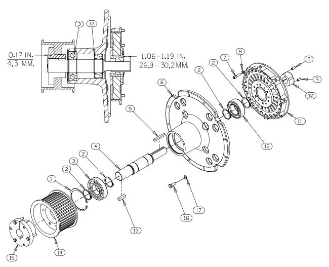
Figure 10. 44162—185 Engine Drive Assembly
